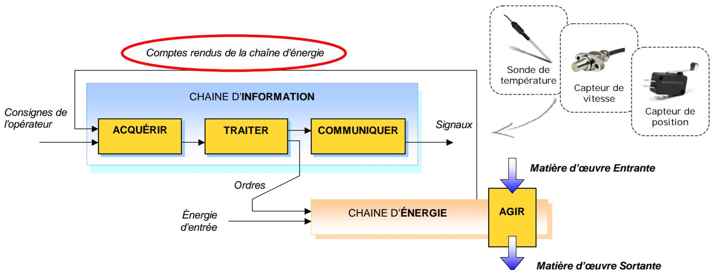
Le composant fondamental permettant d'acquérir une grandeur physique s'appelle « **CAPTEUR** » ; dans certaines situations, on parle aussi de « **DETECTEUR** » (de présence par exemple) ou de « **CODEUR** » (voir codeur incrémental).
